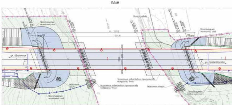
последующий демонтаж моста. Следующий этап – возведение новых опор и пролетов. Также заново будут укреплены монолитным бетоном откосы насыпи и регуляционные сооружения. На вновь возводимом объекте предусматривается сооружение двух комплексов для очистки поверхностных стоков с автодороги.
